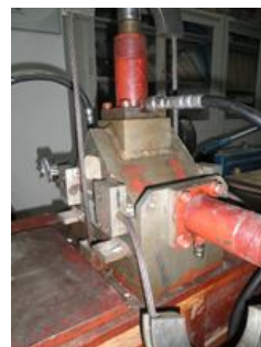
图 3 便携式剪切仪 Fig.3 Portable shear apparatus
